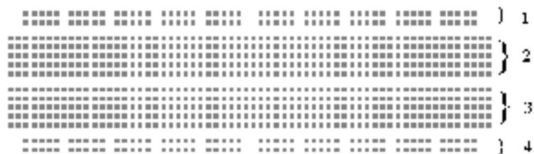
La tableta experimental esta dividida en cuatro secciones, y cada una de estas se encuentran separadas por un material aislante. Los puntos de cada seccion estan conectados entre si tal como lo muestra la figura:
