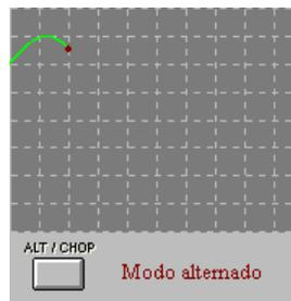
Modo alternado se traza la señal del canal I y después la del canal II
