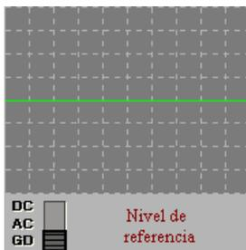
Conmutador de tres posiciones que conecta eléctricamente a la entrada del osciloscopio a la señal exterior
