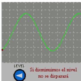
Permite en el modo de disparo manual, ajustar el nivel de señal a partir del cual, el sistema de barrido empieza a actuar. Este ajuste no es operativo en modo de disparo automático.
